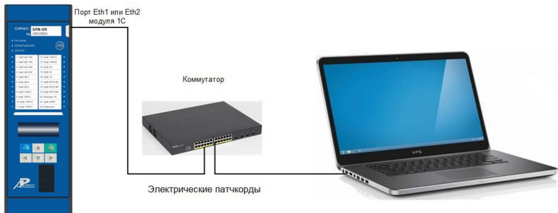
Рисунок 6 – Схема подключения ПК к терминалу Сириус-3ЛВ-05
