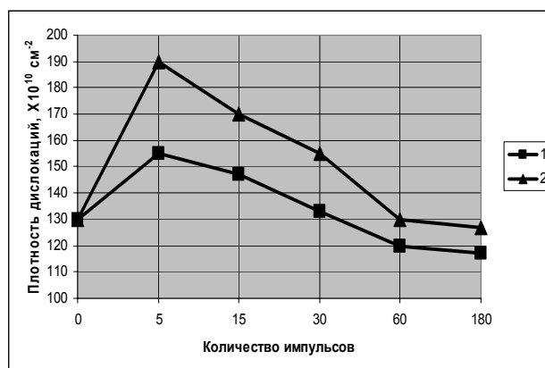
Рис. 1. Изменение плотности дислокаций на поверхности металла: 1 – H = 300 \text{ кА/м} ; 2 – H = 500 \text{ кА/м}
