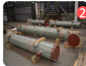
Главный циркуляционный трубопровод ГЦТ
