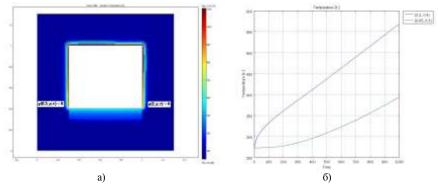
Рис. 2. Распределение температур по сечению заготовки и кладки (а) и изменение температуры теплового центра и самой разогретой точки заготовки во времени (с учетом граничных условий II рода) (б)
