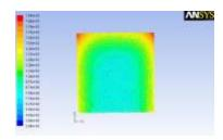
Рис. 1. Температурное распределение по сечению заготовки в пакете ANSYS
