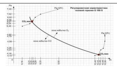
Рис. 2. Регулировочная характеристика горелки G 100 S
