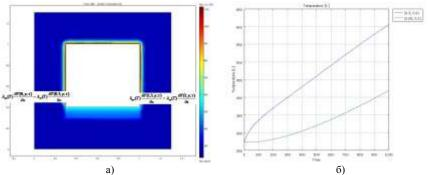
Рис. 1. Распределение температур по сечению заготовки и кладки (а) и изменение температуры теплового центра и самой разогретой точки заготовки во времени (с учетом граничных условий IY рода)(б)
