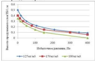
Рис. 2 Зависимость высоты продуваемого слоя от его плотности
