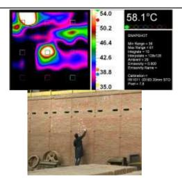
Рис. Результаты тепловизионного обследования стенки печи
