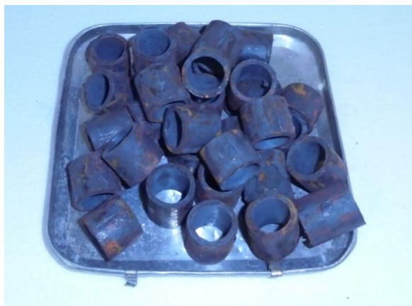
Рисунок 3.5. Конструктивные элементы садки - кольца d_{к1}=22 мм
