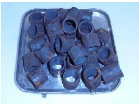
Рисунок 3.4. Конструктивные элементы садки - кольца d_{к2}=32 мм
