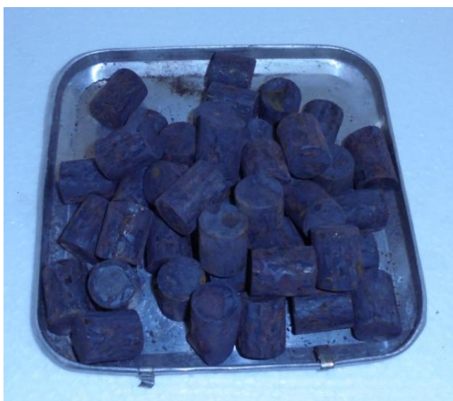
Рисунок 3.6. Конструктивные элементы садки - короткие цилиндры
