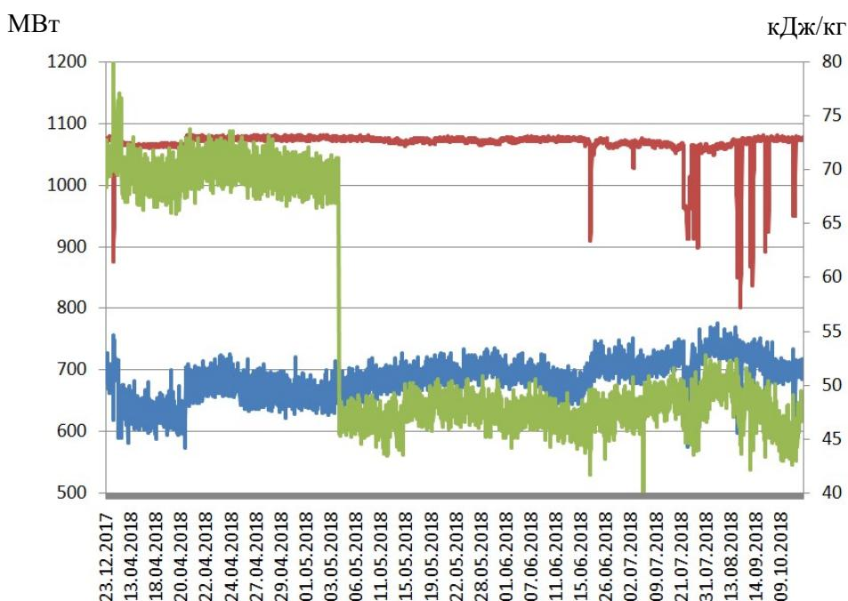
**Рисунок 3.4. Удельные расходы тепловой энергии брутто на ПТН №1 и №2 в период с 23.12.2017 по 09.10.2018:** обозначения — те же, что на рисунке 3.3
