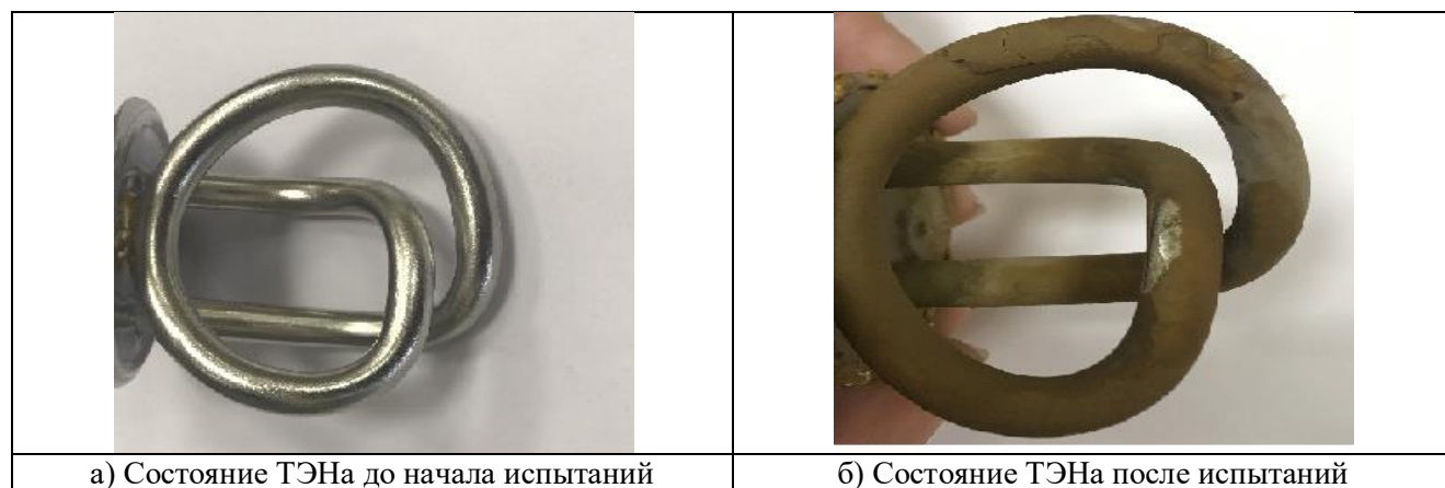
Рис. 3.1. Фотографии ТЭНа до и после испытаний
