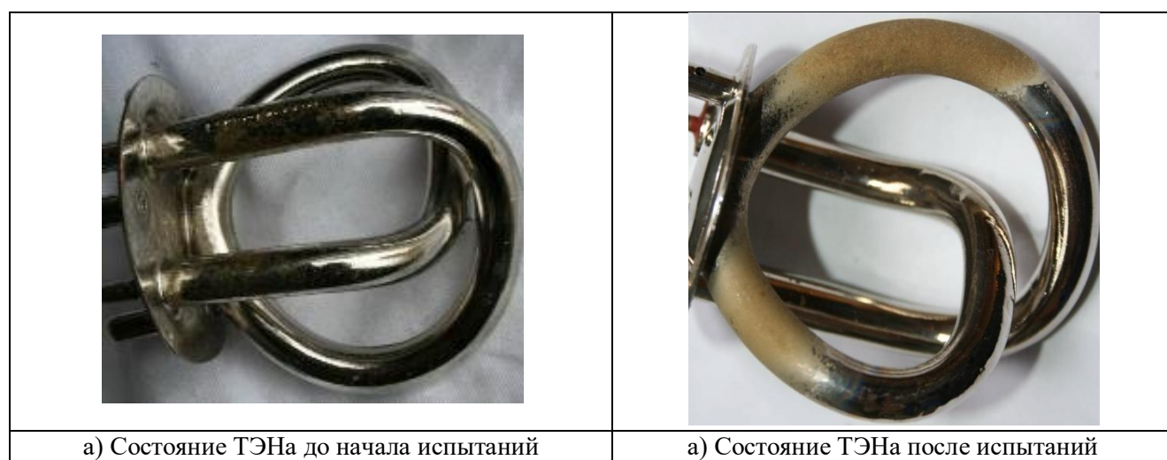
Рис. 3.9. Фотографии ТЭНа до и после испытаний
