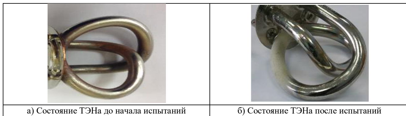
Рис. 3.7. Фотографии ТЭНа до и после испытаний
