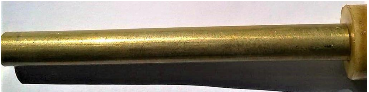
Рис. П. 5.2. Внешний вид индикатора коррозии во время осмотра 24.07.18 (18 дней в потоке)
