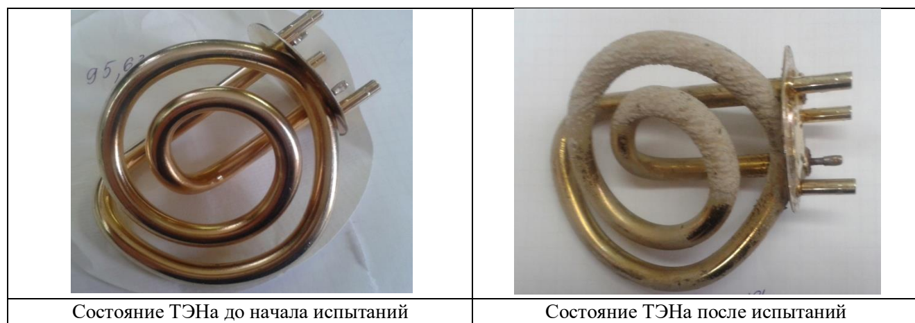
Рис.3.3. Фотографии ТЭНа до и после испытаний
