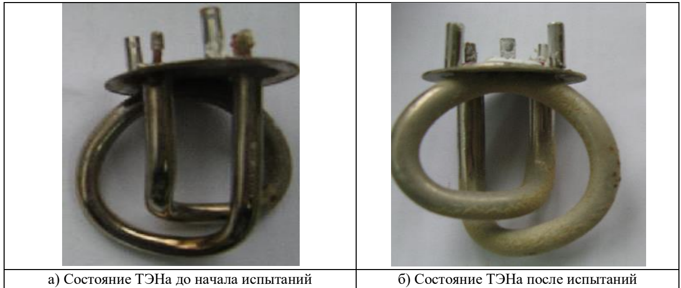
Рис. 3.5. Фотографии ТЭНа до и после испытаний
