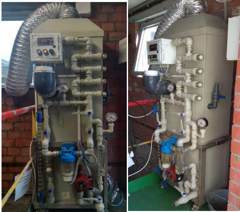
Рис. 5.3. Внешний вид стендовой установки, моделирующей работу системы оборотного охлаждения.
