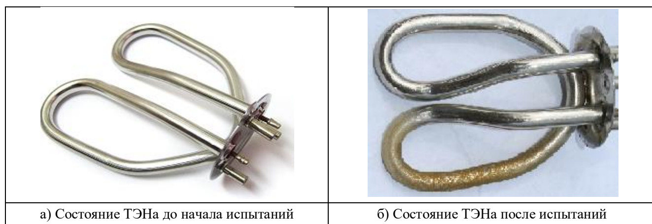
Рис. 3.11. Фотографии ТЭНа до и после испытаний
