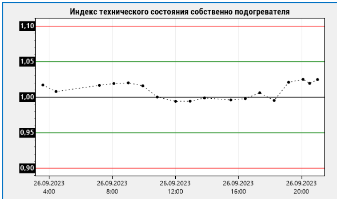
Рисунок 4.28. Контрольная карта технического состояния регенеративного подогревателя типа ПВ-900-380-66. Прочие обозначения приведены в тексте
