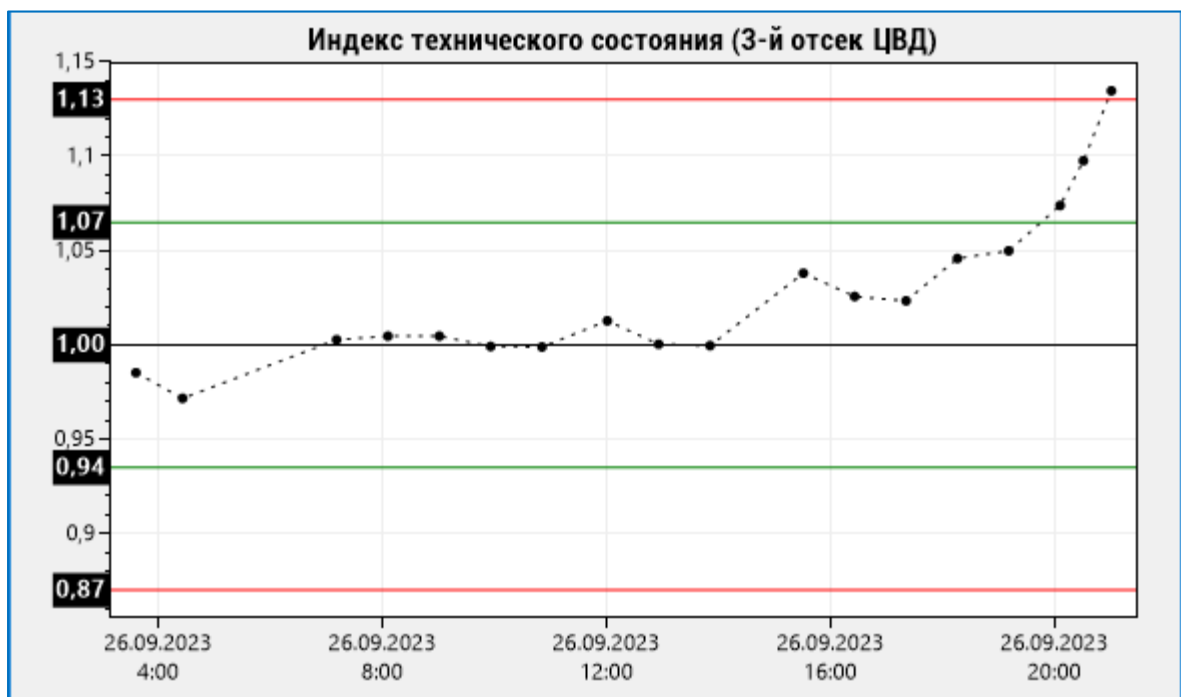
Рисунок 4.25. Карта технического состояния 3-го отсека ЦВД турбины типа К-300-240 ЛМЗ с учетом тестовых модельных возмущений, характеризующих увеличение относительной площади проходного сечения турбинных решеток отсека. Прочие обозначения приведены в тексте
