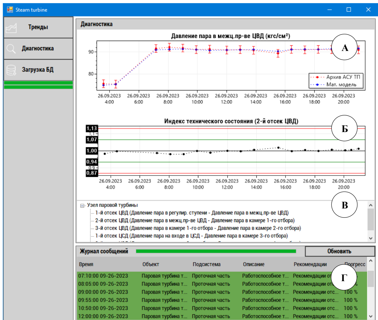
Рисунок 4.23. Экранная форма программного комплекса по анализу технического состояния на примере проточной части паровой турбины типа К-300-240 ЛМЗ (Костромская ГРЭС). Прочие обозначения приведены в тексте
