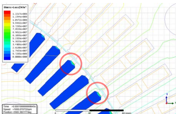
Рис. 2. Фрагмент результатов картины поля потерь в стержнях ротора, полученный при моделировании режима холостого хода электродвигателя АДБС-1200-6У2.
