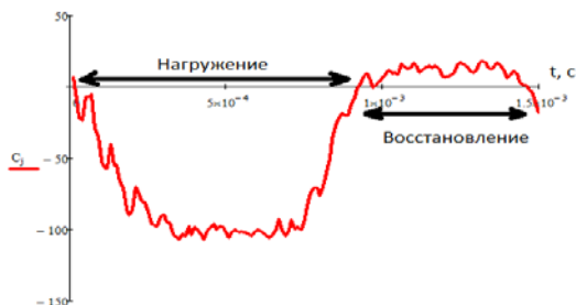
Рис. . Взвешивающая функция при хорошем состоянии смазки подшипника
