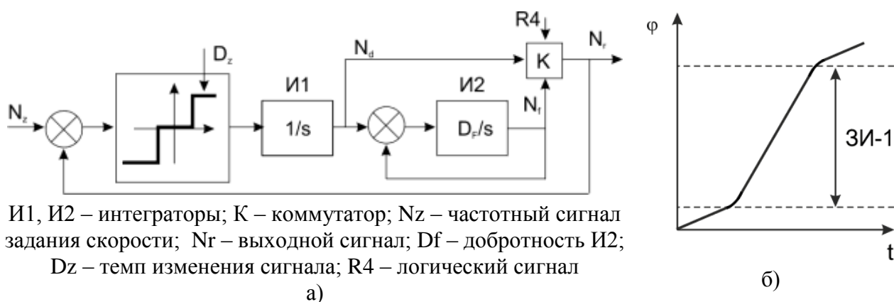
Рис. 7. Программный узел: а) функциональная схема узла; б) вид формируемой кривой
