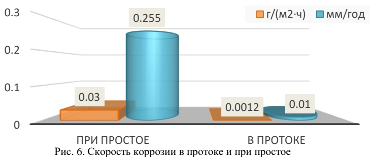
Рис. 6. Скорость коррозии в протоке и при простое
