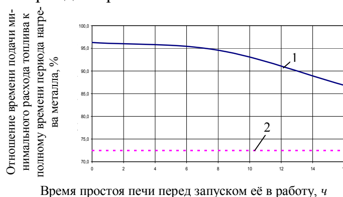
Рис. 15. Влияние количества часов простоя садочной печи на продолжительность времени подачи топлива в период нагрева металла с минимальным расходом топлива: 1 – отношение времени подачи минимального расхода топлива к общему времени нагрева; 2 – ограничение времени подачи минимального расхода топлива к общему времени нагрева (печь находилась после длительного простоя)
