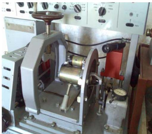
Рис. 7. Фото экспериментальной установки со стартером
